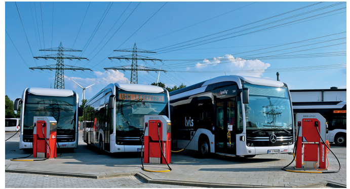
Ein intelligentes Lademanagementsystem sorgt dafür, dass alle Fahrzeuge bedarfsgerecht, kostengünstig und batterieschonend geladen werden (© Ulrike Kabel/INIT)
